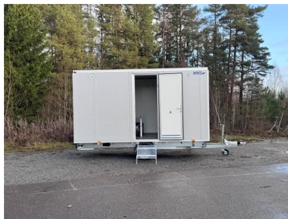
Isolert med 50mm stålplate sandwich isolering. Nedfellbar trapp for enkel adkomst og teleskop støtteben
