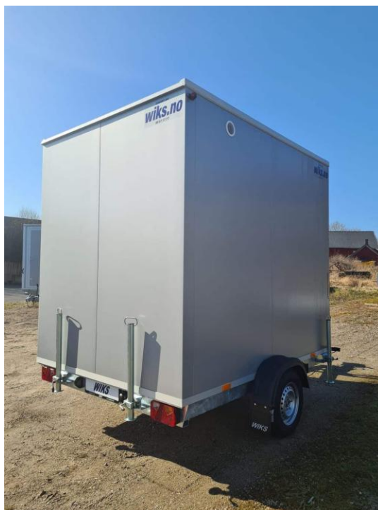
Støttebein for stabil plassering. Hengeren er isolert med 50mm stålplate sandwich isolering og har dessuten isolert gulv.
