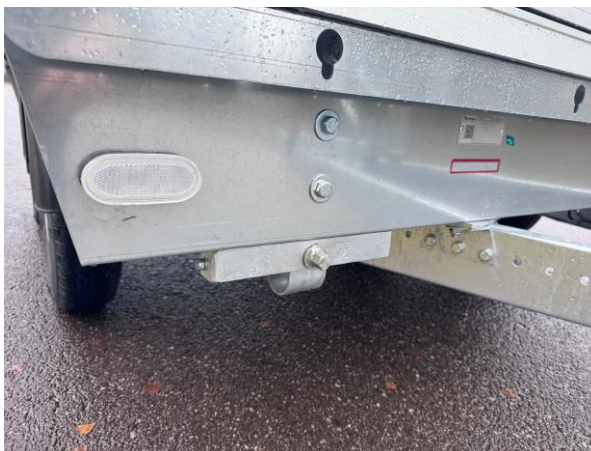
Detaljbilde markeringslys i front og skrue for nedfelling av støtteben. Sveiv medfølger.
