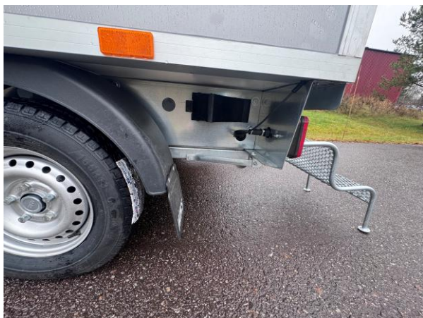
Detaljbilde hjulstoppere og teleskop støtteben
