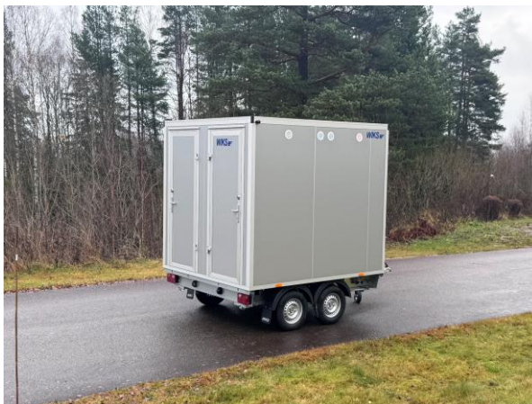
Hengeren er isolert med 50mm stålplate sandwich isolering
